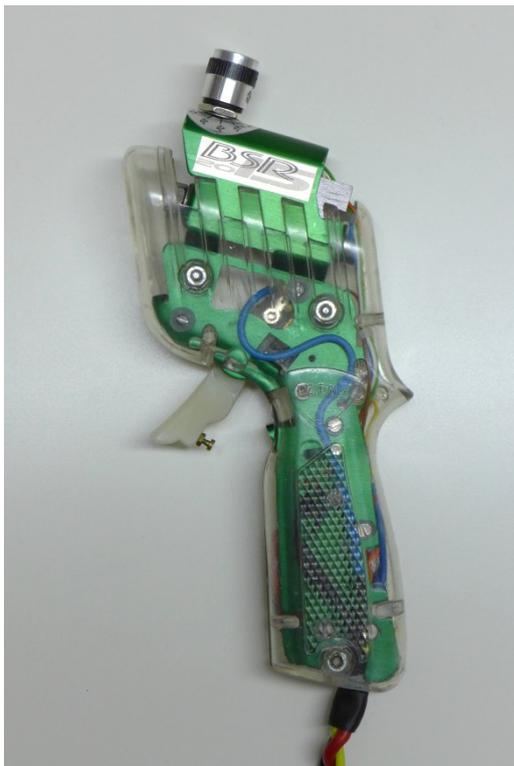
Das Kabel zum Triggerarm habe ich in der „Parma-Variante“ verlegt. D.h. auf der Unterseite des Aluchassis ein großes S aus 0,75 mm<sup>2</sup> Messkabel. Das ist schön flexibel und hat sich bei meinem alten Regler bewährt.
